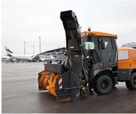
Die Supra 5002 ist eine selbst-fahrende Schneeräummaschine mit wahlweise eine Räumbreite von 2400, 2600 oder 2800 mm.
