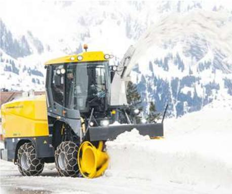
La Supra 4002 es una fresadora de nieve autopropulsada con una anchura de limpieza de 2400, 2600 o 2800 mm.
