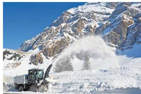
La Supra 5002 de gran capacidad puede equiparse con extensiones delanteras accionadas hidráulicamente, especialmente útiles en aeropuertos. Esto aumenta el ancho de limpieza y puede adaptarse de forma flexible al ancho de la capa de nieve, permitiendo una retirada de la nieve especialmente eficiente. Además de su gran eficiencia de limpieza, la tracción total de la Supra la hace muy maniobrable, lo que es muy importante en zonas estrechas de los aeropuertos y cerca de los aviones.
