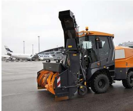
La Supra 5002 es una fresadora de nieve autopropulsada con una anchura de limpieza de 2400, 2600 o 2800 mm.
