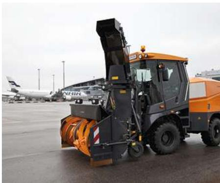
La Supra 5002 è una macchina sgombraneve semovente con una larghezza di sgombero di 2400, 2600 o 2800 mm.
