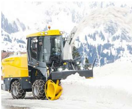
La Supra 4002 è una macchina sgombraneve semovente con una larghezza di sgombero di 2400, 2600 o 2800 mm.
