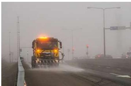
Шланг на катушке наматывания с электроприводом и все форсунки поливомоечных систем SCW размещаются на передней моющей головке, которая монтируется как фронтальное навесное оборудование на базовом шасси без необходимости использования дополнительных подъемных устройств. Мощная головка оборудована собственным подъемным механизмом для регулировки рабочей ширины и силы воздействия струй воды на дорожную поверхность.
