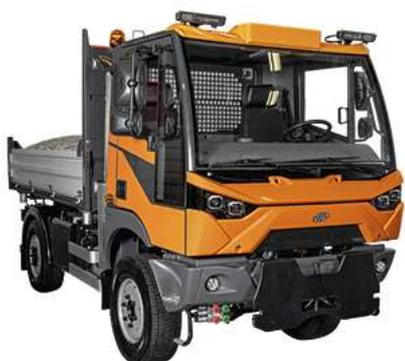
Il **carico utile massimo** di **3800 kg** e la ricca attrezzatura di base di MT 760 permettono **impieghi giornalieri** in ogni stagione. Il **peso complessivo** si aggira sui **6500 kg**.
