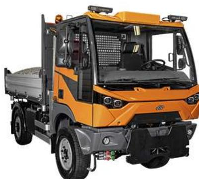
Il **carico utile massimo** di **4800 kg** e uno scarico idraulico sulla parte anteriore del veicolo rendono MT 770 un partner affidabile per **lavori impegnativi**. Il **peso complessivo** si aggira sui **7500 kg**.
