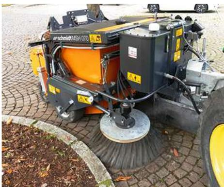
La MSH 070 dispose d'une cuve à déchets d'une capacité de 0,7 m<sup>3</sup>
