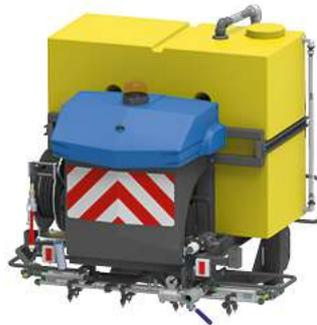
El CSP T 650 tiene un tanque de salmuera con una capacidad de 650 l.
