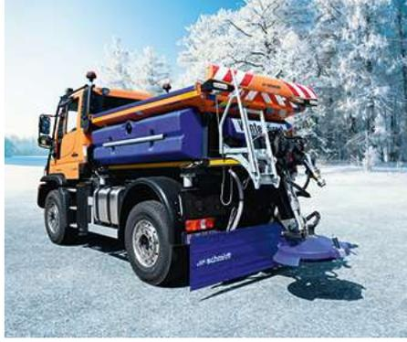
Der Stratos F25 ist eine Flachsilobstreumaschine mit einer Behältergrösse von 2,5 m<sup>3</sup>.
