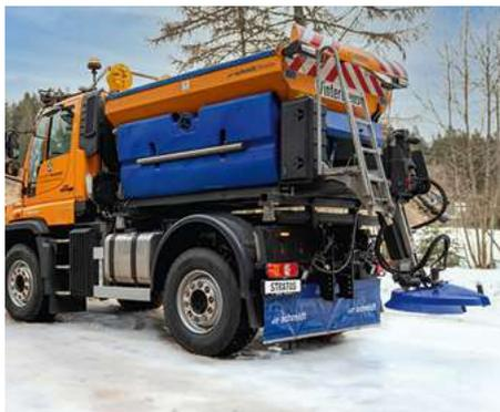
La saleuse Stratos 25 est un épandeur avec une capacité de 2,5 m<sup>3</sup>.
