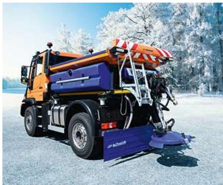
La saleuse Stratos F25 est un épandeur à trémie basse avec une capacité de 2,5 m<sup>3</sup>.
