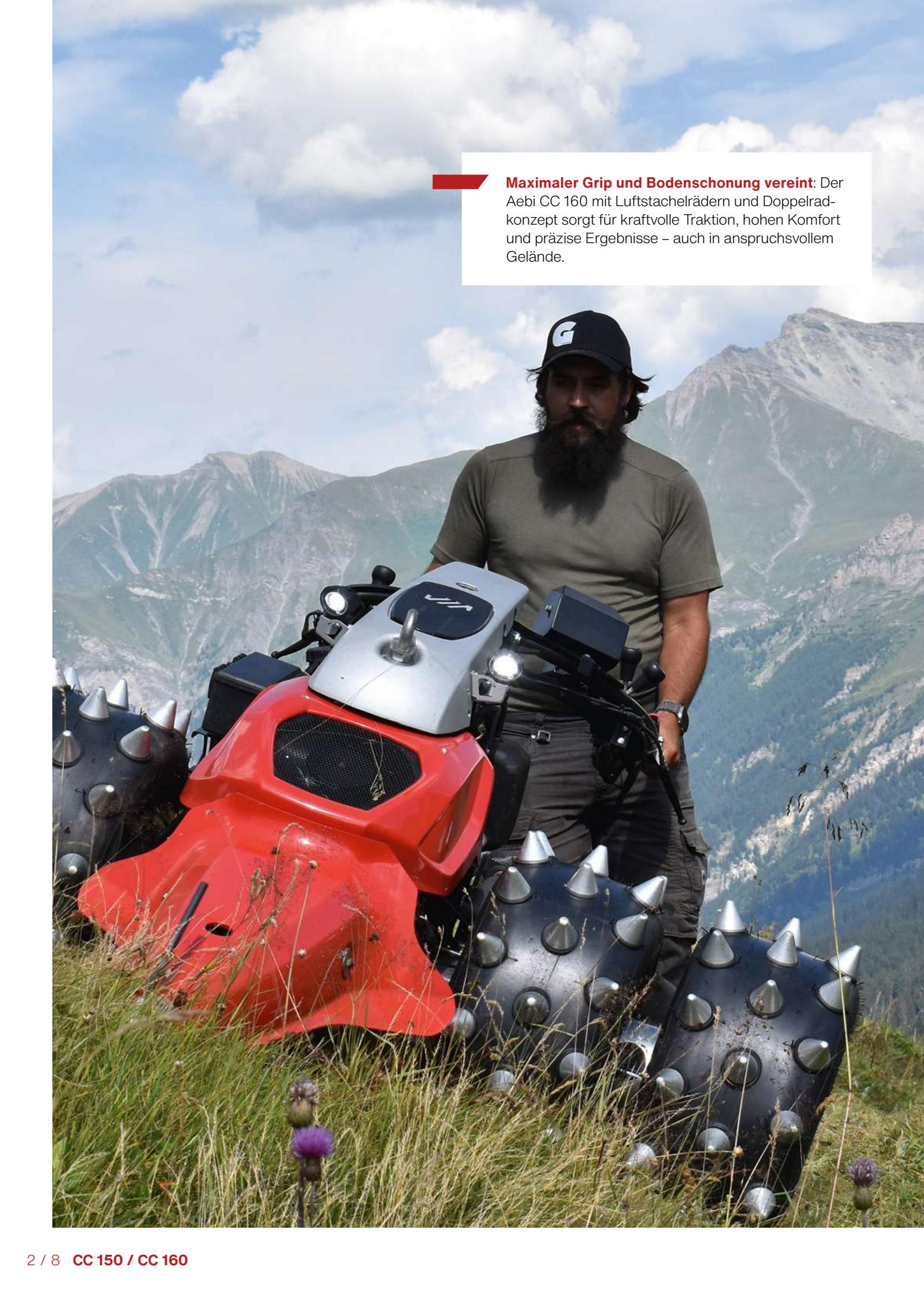
**Maximaler Grip und Bodenschonung vereint:** Der Aebi CC 160 mit Luftstachelrädern und Doppelradkonzept sorgt für kraftvolle Traktion, hohen Komfort und präzise Ergebnisse – auch in anspruchsvollem Gelände.
