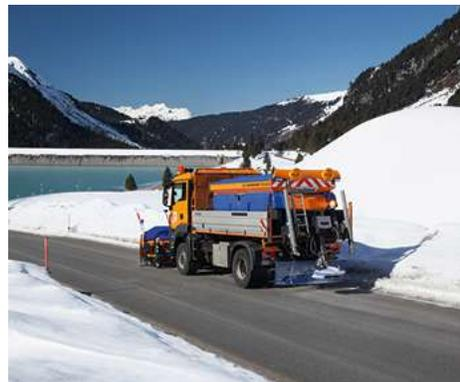
La saleuse stratos 50 est un épandeur porté avec une capacité de 5 m<sup>3</sup>
