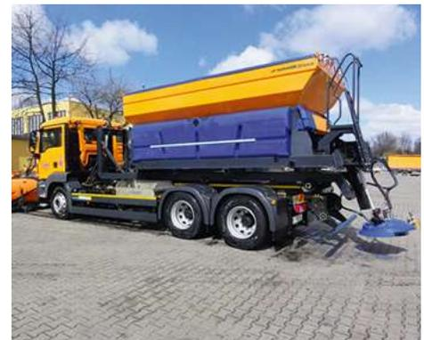
La saleuse Stratos 100 est un épandeur porté avec une capacité de 10 m<sup>3</sup>
