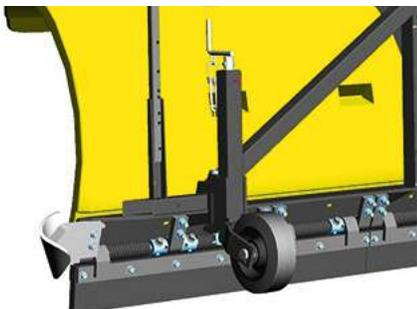
2. Ruedas giratorias SNK ajustables mediante arandelas
