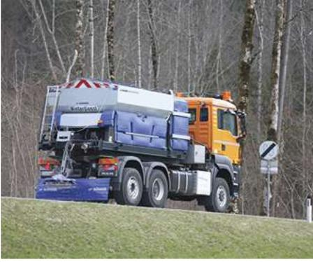
El Stratos RSP 50K Flex High tiene una tolva de 5,0 m<sup>3</sup> de capacidad con dos bolsas Flex integradas y va equipado con el sistema de distribución RSP.
