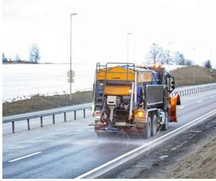
El Stratos WSP 50K tiene una tolva de 5,0 m<sup>3</sup> de capacidad y lleva instalado el sistema de distribución WSP.
