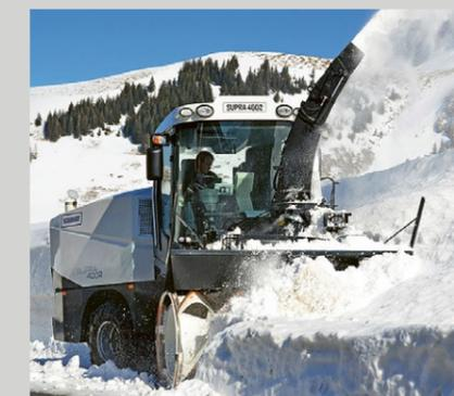
Die Schneefrässchleudern werden für das schnelle und grossflächige Säubern von Waffen-, Schiess- und Ausbildungsplätzen sowie für das Öffnen von Zugangsstrassen und teils öffentlichen Strassen und Wegen eingesetzt.
