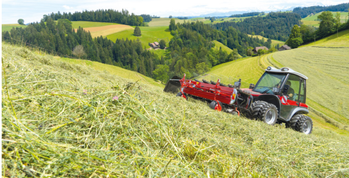
Alle Terratrak-Modelle sind für Arbeiten am Hang mit optimaler Gewichtsverteilung ausgelegt.
