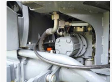
Die Hydraulikpumpe des TT 211+ leistet neu 40 l/min statt den bisherigen 30 l/min.
