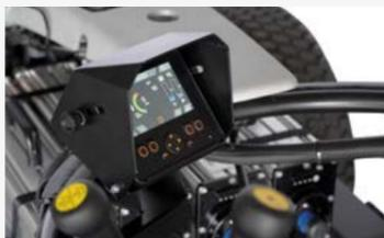
Alles im Blick: Das 4.3" Display zeigt alle Einsatzdaten und die Restkapazität der Akkus an.
