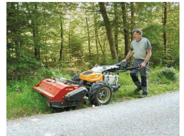
Die Maschine arbeitet auch mit leistungsintensiven Anbaugeräten wie Mulchern oder Schneefräsen.
