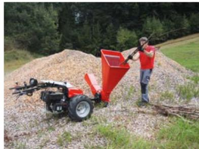
Mulchen, kehren, Laub blasen oder wie hier als stationärer Antrieb für einen Häcksler. Der Combicut kann fast alles.
