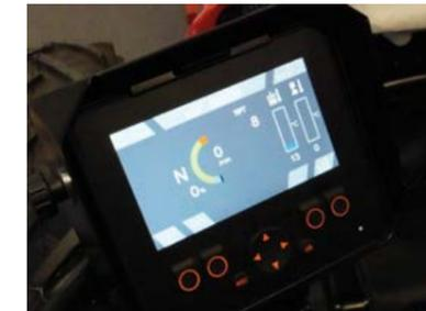
Das beim CC 160 optional erhältliche 4,3" Grafikdisplay zeigt stets sämtliche Einsatzdaten. Das Display kann zusätzlich als Service- und Analysetool verwendet werden.
