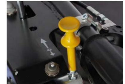
Der gelbe Fahrhebel steuert die Fahrgeschwindigkeit stufenlos auf leichten Daumendruck.
