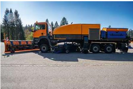
La CJS-DI peut être montée en série sur le véhicule porteur MAN TGS 18.320, de type châssis. Ce véhicule porteur présente un rayon de braquage de 18 mètres et offre l'option d'une direction supplémentaire de l'essieu arrière pour une plus grande agilité. L'exécution de base et la norme d'émission gaz de la motorisation (jusqu'à Euro6) du véhicule porteur sont à définir suivant le client / réglementation pays.
